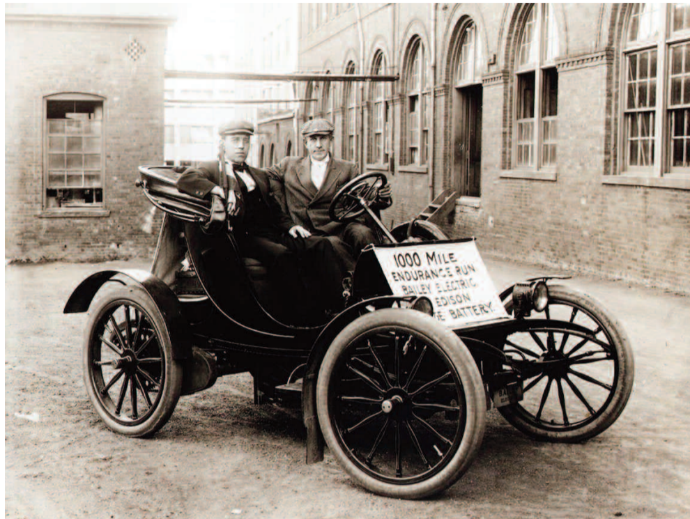
Το ηλεκτρικό αυτοκίνητο που κατασκεύασε ο Bailey 1910, κάλυψε απόσταση 1600 χιλιομέτρων με αλκαλικές μπαταρίες του Thomas Edison.
