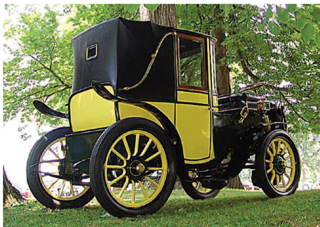
Το 1903 ο Krieger κατασκευάζει το πρώτο υβριδικό αυτοκίνητο. Ήταν ένα εμπροσθοκίνητο όχημα με ηλεκτρισμό και βενζίνη που είχε υδραυλικό τιμόνι.
